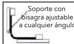
Utilice plantillas fijas o ajustables para mantener la pieza en el ángulo deseado.
